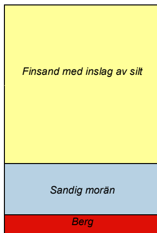
Figur 4: Principiell skiss över dimensionerande jordlagerföljd på sträckans västra del.
