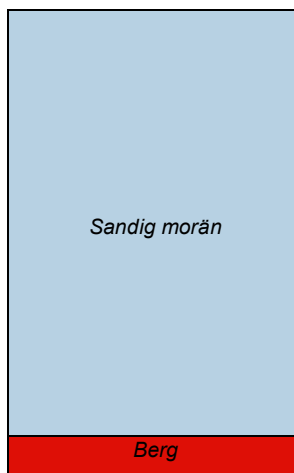
Figur 5: Principiell skiss över dimensionerande jordlagerföljd på sträckans östra del.
